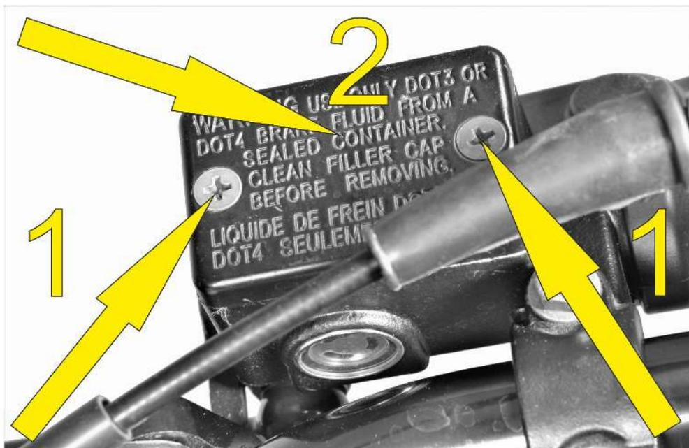
Установите тормозной цилиндр в горизонтальное положение и заполните бачок
